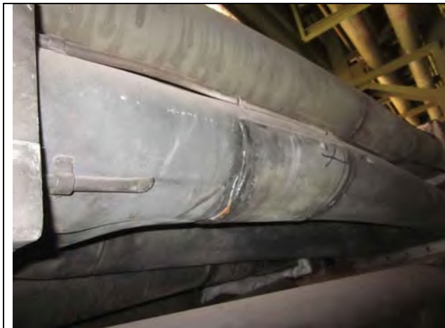
رادیان تیوب تعمیر شده بوسیله Sleeve
