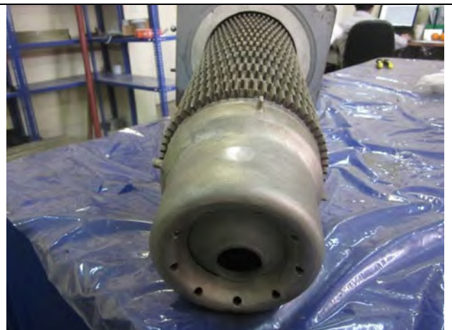
نمونه نازل خارجی نصب نشده
