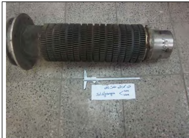
نمونه نازل داخلی نصب نشده
