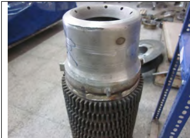
سر نازل جوش داده شده به بدنه خارجی
